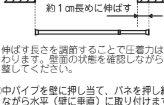
\*伸ばす長さを調節することで圧着力は変わります。壁面の状態を確認しながら調整してください。
