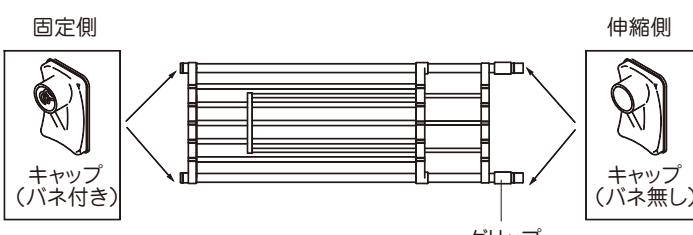
**3** 棚の下図2箇所に長さ固定ねじを2~3回転ほど軽く回し仮付けしておきます。(この時、回しすぎると調整パイプが引き出せなかったり、傷が付きますので注意してください)
