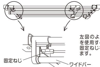
左図のようにワイドバーを使用する角度に合わせ、固定ねじを締めて固定します。
