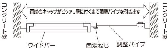
固定ねじを根元まで締め付けると、調整パイプに穴があいて長さが固定されます。
