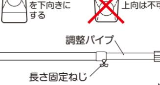
●必ず水平(壁面に垂直)にし、安定キャップが壁についているか確認してください。
