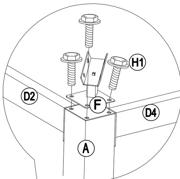
Please measure to make sure the length of d1 is equal to d2 before moving to next step to ensure a square frame and best results. Keep the beam at right angles to the post, the post at right angles to the ground, and keep the beam horizontal. /Avant de passer à l'étape suivante, veuillez prendre des mesures pour vous assurer que la longueur de d1 est égale à celle de d2 afin d'obtenir une armature carrée. Maintenez la traverse à l'horizontal en angle droit par rapport au montant et le montant en
