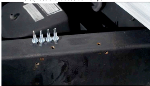
Fig. 4 – Avant-trous montrés avec les vis à tôle incluses.
