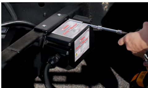
Fig. 5 - Usando un casquillo de 3/8", fije la unidad Sway Master™ al remolque con los tornillos autorroscantes suministrados.
