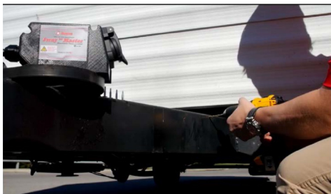
Fig. 3 - Perfore agujeros en la extensión del remolque.
