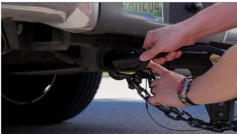
Fig. 7- Insérez la fiche Sway Master MC dans la douille à 7 voies. Insérez la fiche à 7 voies de la remorque dans la douille Sway Master MC .
