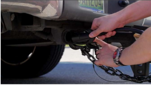
Fig. 7- Inserte el enchufe del Sway Master™ en el receptáculo de 7 entradas. Inserte el enchufe de 7 puntas del remolque en el receptáculo del Sway Master™.
