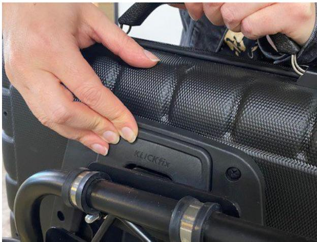
Für die Demontage des Koffers, einfach auf die obere Entriegelungstaste drücken und Koffer nach oben aus der Trägerplatte herauschieben.
