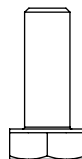
3x Bout M6 x 16 mm / Bolt M6 x 16 mm / Bolzen M6 x 16 mm
