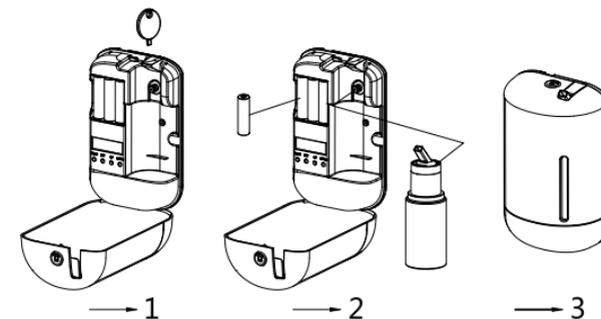
1. Mit Schlüssel die Abdeckung entriegeln und Tank entnehmen.
