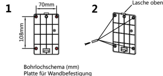
3. 1. Schraubenloch im Gerät und Lasche der Platte Wandbefestigung ausrichten.
