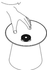
1. Drehen Sie die Stopfbuchse gegen den Uhrzeigersinn, um die Schale leicht zu lösen (dies ermöglicht eine einfache Reinigung).
