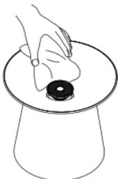
2. Verwenden Sie ein sauberes Tuch oder einen Tücher, um die Unterseite der Stopfbuchse und der Schale zu reinigen. Sie können auch fließendes Wasser verwenden, um das Gerät gründlicher zu reinigen, solange der Deckel vom Sockel abgenommen ist.
