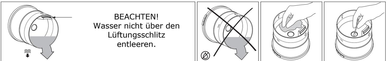
3. Reinigen Sie das Innere des Aroma Diffusers mit klarer Essigessenz, etwas Wasser und einem weichen Tuch. Benützen Sie keine Scheuermittel. Das Keramik Ultraschall Membran nur **mit einem Wattestäbchen** vorsichtig reinigen. Üben Sie dabei keinen Druck aus und verwenden Sie keine scharfen Gegenstände. Achten Sie darauf, dass Sie das Membran nicht verkratzen und nicht beschädigen.
