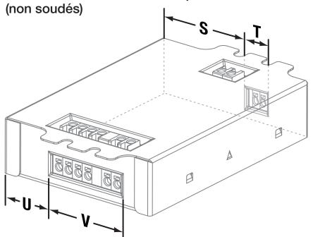
S 35 mm (1,38 po) T 16 mm (0,64 po) U 22 mm (0,88 po) V 39 mm (1,53 po)
