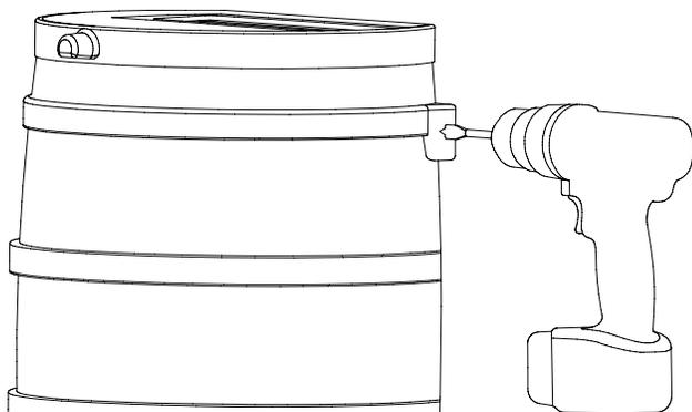
**2** Insérez l'extrémité fileté de l'embout de tuyau dans le trou de 1 pouce.
