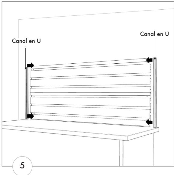
**5.** Utilice el canal en U provisto para ocultar el borde de las tablillas y brindar una apariencia de acabado adecuado. Deslice el canal en U a lo largo de un lado de las tablillas, **apretando completamente los tornillos de ese lado para sujetarlo en su lugar.** Repita el procedimiento para el canal en U opuesto.
