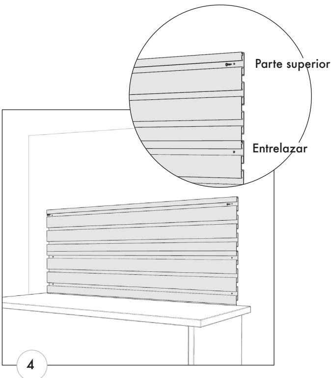
4. Para paneles de listones adicionales, atornille solo en la parte superior.
