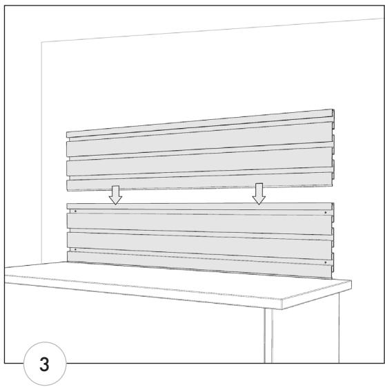
3. Placer la prochaine latte sur celle installée à l'étape 2. Vérifier le niveau.
