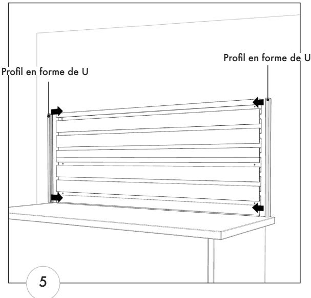
5. Utiliser les profils en forme de U fournis pour cacher les extrémités des panneaux et ainsi donner un aspect fini. Glisser un profil en forme de U le long d'un côté, et serrer complètement les vis afin de maintenir le tout en place. Répéter cette procédure pour l'autre côté.
