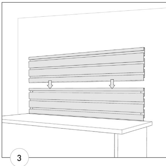
3. Coloque la siguiente sección del perfil de panel ranurado en el perfil del paso 2). Comprobar nivel.
