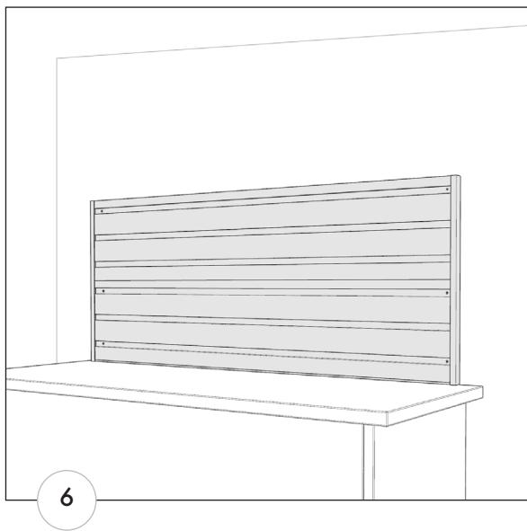
**6.** Use la **pintura de retoque** provista para pintar las cabezas de los tornillos y crear una apariencia uniforme con el resto de su panel de listones.
