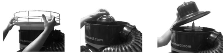
Nettoyer soigneusement toutes les parties, et le bloc de la machine à l'eau froide et de détergent.
