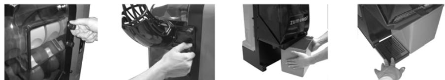
**Minimatic:** dévisser la vis à ailettes et la vis de la tête d'alimentation, placez le tube d'alimentation. Placer le godet peel et le jus bac.
