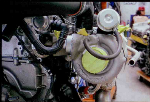
ターボはギャレット製のHGP-R30というモデルだ。アクチュエーター一体式のタービンになる。EXマニホールドはキットに付属する。
