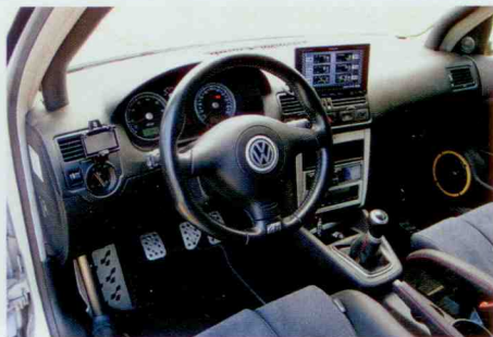
コックピットにはHKSのCAMP2を設置。油温、油圧、水温、そしてブーストの表示が可能だ。
