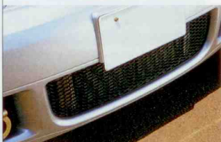
バンパー奥に設置されているインタークーラー。ターボの効率を最大限に上げるため、インタークーラーは空冷と水冷のシステムを持つ。
