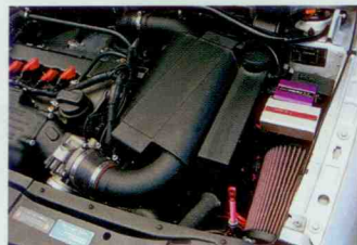
↑HPA FT465ターボキットを装着して465psとなったエンジン。巨大なインターマニホールドやつや消し黒の塗装がスバルタンな印象を与える。
