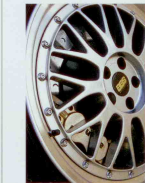
ホイールは2ピース鍛造のBBS LMの18インチ。主にドレスアップ目的で街乗り用として使用。サーキットではレイズのCE28に履き替える。
