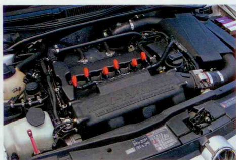
↑HPA FT465ターボキットを装着して465psとなったエンジン。巨大なインターマニホールドやつや消し黒の塗装がスバルタンな印象を与える。
