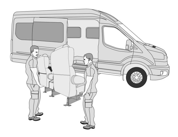
3. INSET THE SEAT LEGS INTO THE VEHICLE FLOOR TRACK RECEIVERS.
