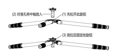
说明:此中轴只限用于与其相同外型尺寸的三脚架.在安装时与三脚架原配的中轴操作方式相同,短中轴没有设挂钩组件,使用时需将中轴安装到位并固定中轴后再操作.
