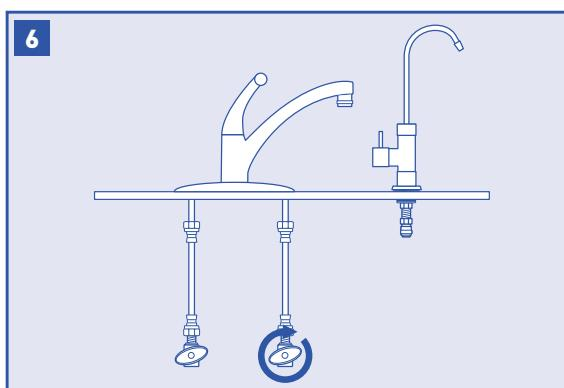
Desconecte la válvula de cierre de agua fría, abra el grifo de la cocina y deje que drene toda el agua de la línea.
