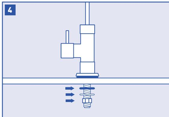
Por debajo del fregadero, guíe la arandela negra por el vástago, seguida de la arandela de seguridad de metal; luego, atornille completamente la tuerca del vástago para grifo en el vástago del grifo y ajuste para fijar el grifo al fregadero.
