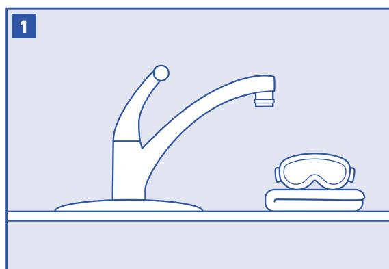
**PRECAUCIÓN:** Para llevar a cabo este procedimiento, se recomienda el uso de gafas de seguridad y mascarilla antipolvo. Para evitar que las partes y los materiales se vayan por el desagüe, cubra el fregadero con un diario o un paño. Coloque cinta de enmascarar alrededor del área donde se debe perforar para evitar rayones si la broca se resbala.
