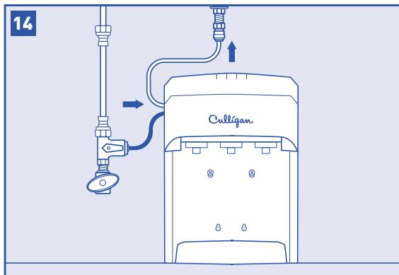
Mouillez l'une des extrémités du tuyau en plastique blanc de 0,325 po et insérez-la dans l'adaptateur du raccord rapide d'alimentation en eau sur environ 0,625 po, jusqu'à l'arrêt.
