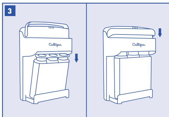
Placez la base de la cassette dans la base du système, puis faites basculer le haut de la cassette vers l'arrière pour qu'elle repose contre le système.
