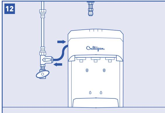
Mouillez l'une des extrémités du tuyau en plastique de 0,325 po et insérez-la dans le raccord d'alimentation en eau sur environ 0,625 po, jusqu'à l'arrêt.
