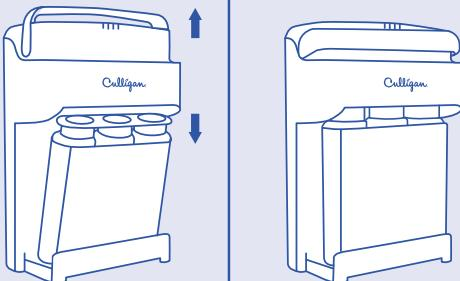
Para desbloquear el sistema, levante la palanca del sistema.
