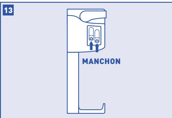
**REMARQUE :** L'entretien courant et le remplacement de la cartouche ne requièrent pas de déconnecter le tuyau de la tête du système; cependant, le tuyau peut être retiré rapidement et facilement du raccord si nécessaire. Tout d'abord, fermez l'alimentation en eau vers le filtre. Ouvrez le robinet de l'évier, puis appuyez sur le manchon autour du raccord tout en retirant le tuyau avec votre autre main.
