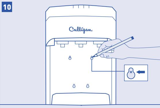
Marquez avec un crayon les trous pour les vis de montage sur la surface du mur en utilisant le support intégré à l'arrière du système.
