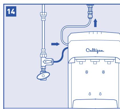
Humedezca un extremo de la manguera de plástico blanca de 1 cm (3/8 in) con agua e inserte, aproximadamente, 1.6 cm (5/8 in) de la manguera en el adaptador para el accesorio del grifo de conexión rápida, hasta que haga tope.
