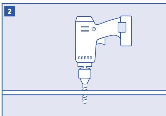
Marquez l'emplacement du trou à forer avec un crayon. Percez un trou pour le robinet (la plupart des évier sont équipés de trous de 1,375 po [3,5 cm] ou 1,5 po [3,8 cm] de diamètre).
