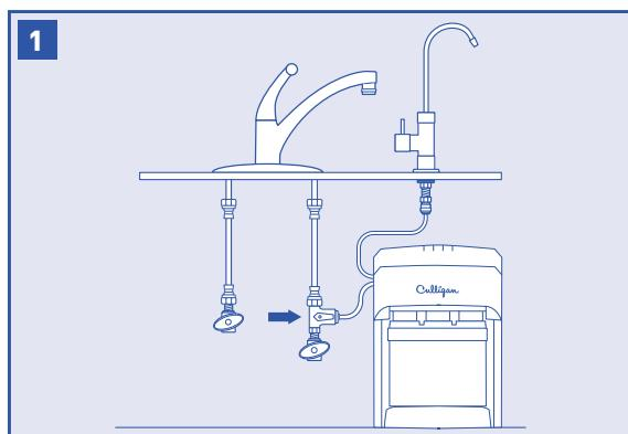
Fermez l'eau froide alimentant le système à l'aide de la vanne d'arrêt de l'adaptateur d'alimentation en eau et laissez couler de l'eau à partir du robinet d'eau potable jusqu'à ce que le débit s'arrête afin de diminuer la pression.
