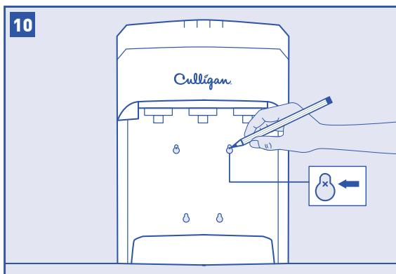
Con el soporte incorporado de la parte posterior del sistema, marque con un lápiz el punto medio de los orificios para los tornillos de montaje en la superficie de la pared.
