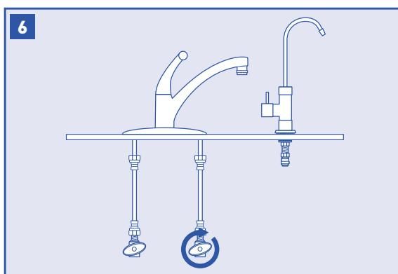
Fermez la vanne d'arrêt de l'eau froide, puis ouvrez le robinet de l'évier et laissez toute l'eau se vider de la conduite.
