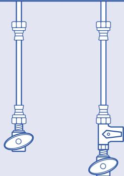
Serrez à la main l'adaptateur d'alimentation d'eau sur la vanne d'arrêt d'eau froide, tel qu'illustré.
