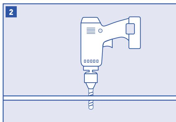
Con un lápiz, marque el orificio que pretende perforar. Realice una perforación para el grifo (la mayoría de los fregaderos tienen orificios de 3.5 cm [1-3/8 in] o 3.8 cm [1-1/2 in] de diámetro). Realice una perforación que atraviese completamente el fregadero o la encimera.
