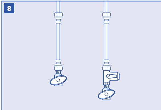
Ajuste manualmente el adaptador para suministro de agua a la válvula de cierre de agua fría, como se muestra.
