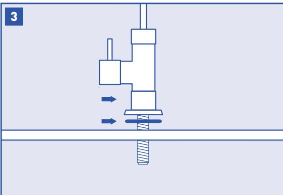
Placez le joint de la base du robinet sur la base, puis placez le robinet lui-même. Faites passer la tige du robinet dans le trou. Assurez-vous que le robinet est bien à plat sur le dessus de l'évier ou du plan de travail.
