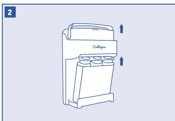
Para desbloquear el sistema, levante la palanca del sistema.
