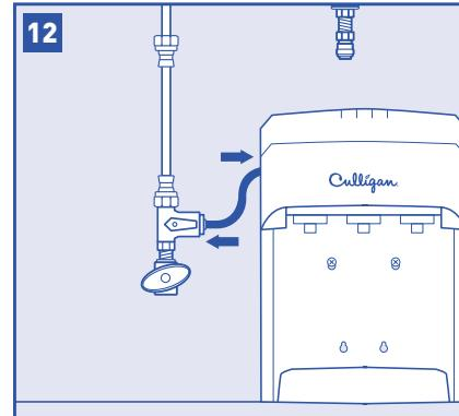
Humedezca un extremo de la manguera de plástico azul de 1 cm (3/8 in) con agua e inserte, aproximadamente, 1.6 cm (5/8 in) de la manguera en el adaptador para suministro de agua, hasta que haga tope.
