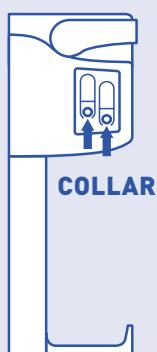
**NOTA:** Las tareas de mantenimiento de rutina y el cambio de cartuchos no requieren que se desconecte la manguera del cabezal del sistema; sin embargo, la manguera puede extraerse del accesorio rápida y fácilmente, en caso de que sea necesario. Primero, corte el suministro de agua al filtro. Abra el grifo de la cocina y presione el collar que rodea el accesorio mientras tira de la manguera con la otra mano.
