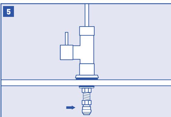
Por debajo del fregadero, ajuste manualmente el accesorio del grifo de conexión rápida al vástago del grifo.
