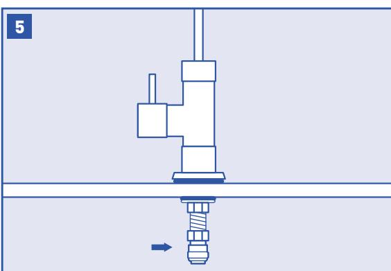
Depuis le dessous de l'évier, serrez à la main le dispositif de raccord rapide du robinet sur la tige de ce dernier.
