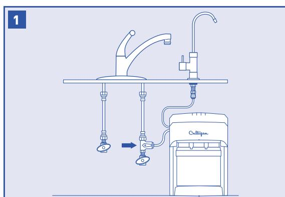
Desconecte el agua fría del sistema con la válvula de cierre de agua del adaptador para suministro de agua y deje correr el agua potable del grifo hasta que se detenga el flujo para liberar presión.
