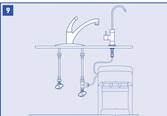
Elija una zona de fácil acceso debajo del fregadero para montar el sistema de filtro.
