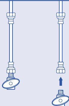
Déconnectez la conduite d'eau froide de la vanne d'arrêt d'eau froide.
