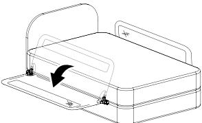
Con ambos lados desatrancados, gire la pared de malla de la barandilla hacia abajo de modo que quede paralela con la superficie superior del colchón.
