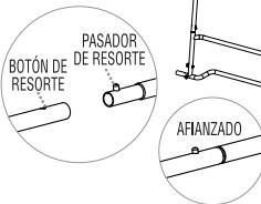
Con las barras de apoyo superior e inferior montados, conecte ambos lados.
