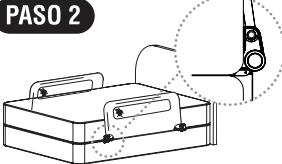
Una vez que se coloque el barandal para cama de modo apropiado, vuelve a colocar el colchón sobre la estructura de ressortes o el soporte, de manera que las barras de metal planas en las bisagras de las esquinas y las correas de sujeción queden entre la estructura de ressortes y el colchón.
