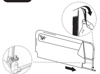
Para instalar la pared de malla (A) en la barandilla, deslícela sobre el marco hasta que llegue al extremo opuesto y cierre la cremallera para completar la instalación. La barrera de malla debe cubrir todo el marco del barandal para cama. Repita los PASOS del 1 al 3 para ensamblar el segundo lado del barandal doble para cama. La barrera de malla debe cubrir todo el marco del barandal para cama.
