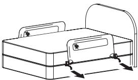
Serrez les sangles pour amener la barrière de lit à sa position adéquate. Afin de resserrer les courroies, dégagéz d'abord les pinces à courroie sous les charnières de plastique. Tirez les courroies vers vous jusqu'à ce que tout le lâche excédentaire ait été retiré de sous le matelas et que les deux côtés du rail de lit soient solidement appuyés sur les bords du matelas.
