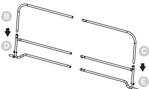
Insérez la barre de support supérieure (C) dans la barre de support inférieure (E). Assurez-vous que la cheville à ressort est bien insérée dans le trou opposé pour verrouiller les deux pièces. Répétez du côté contraire (B, D) du rail de lit.
