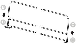
Introduzca la barra de apoyo superior (C) en la barra de apoyo inferior (E). Cerciórese de que el pasador de resorte encaje firmemente en el orificio opuesto de modo que las dos piezas no puedan separarse. Repita en el lado opuesto de la barandilla (B, D).
