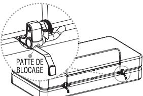
La barrière de lit étant en position verticale, poussez les pattes de blocage vers le bas pour fixer la barrière de lit en place.
