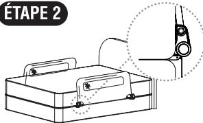
Après avoir installé le rail de lit correctement, reposez le matelas sur le sommier ou sur la base de lit, en coincant les barres de métal plates contre les charnières de coin et les courroies d'ancre entre le sommier et le matelas.
