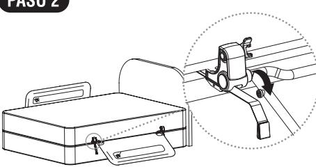
Con ambas lengüetas trabantes giradas hacia la posición 'abierta', sujeté firmemente la parte superior de la barandilla y muévala hacia abajo. Ahora la barandilla debe estar en posición bajada. Para devolver la barandilla a la posición de 'arriba', invierta los PASOS 1 al 2.
