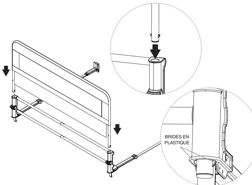
**REMARQUE :** Les verrous de l'assemblage du rail inférieur doivent être en « position déverrouillée » pour insérer l'assemblage des rails supérieur et inférieur.
