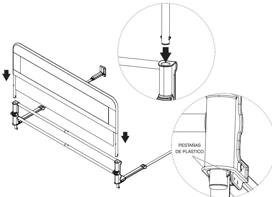
**NOTA:** Los bloqueos del ensamble del riel inferior deben estar en la “posición de desbloqueo” para insertar el ensamble del riel superior e inferior.
