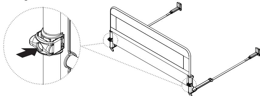
**NOTA:** La parte superior de ambas pestañas de plástico debe apoyarse contra la parte inferior de la abrazadera para montaje.
