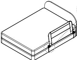
Una vez que la barandilla quede correctamente situada, verifique que los conjuntos derecho e izquierdo de traba giratoria y correas queden paralelos entre sí. Luego coloque el colchón sobre el conjunto.
