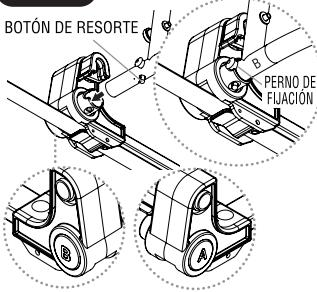
Inserte un lado del marco de la pared con el pasador de ubicación en el conjunto de la bisagra con la etiqueta "B". Presione el botón de resorte metálico para introducir completamente el tubo en el orificio de la bisagra plástica. El botón de resorte debe quedar alineado con el orificio de acceso en el mangúito plástico de la bisagra. El botón de resorte rebotará y trabará el tubo en su lugar. Repita en el conjunto de bisagra opuesta "A".
