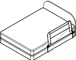
Una vez que la barandilla quede correctamente situada, verifique que los conjuntos derecho e izquierdo de traba giratoria y correa queden paralelos entre sí. Luego coloque el colchón sobre el conjunto.
