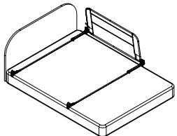
Placez d'abord la barrière de lit du côté du lit où vous avez choisi de l'installer. Les ensembles de verrous basculants gauche et droit et de sangle doivent être placés sur le dessus du sommier qui supportera le matelas. Allongez les sangles et les ancrages en forme de «T» jusqu'au côté opposé de la barrière de lit et montez-les du côté extérieur du sommier du matelas ou de la structure du support du matelas.
