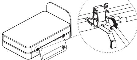
Con ambas lengüetas trabantes giradas hacia la posición 'abierta', sujeté firmemente la parte superior de la barandilla y muévala hacia abajo. Ahora la barandilla debe estar en posición bajada. Para devolver la barandilla a la posición de 'arriba', invierta los PASOS 1 al 2.
