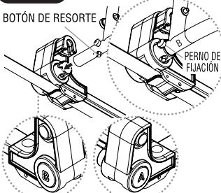
Inserte un lado del marco de la pared con el pasador de ubicación en el conjunto de la bisagra con la etiqueta 'B'. Presione el botón de resorte metálico para introducir completamente el tubo en el orificio de la bisagra plástica. El botón de resorte debe quedar alineado con el orificio de acceso en el manguito plástico de la bisagra. El botón de resorte rebotará y trabará el tubo en su lugar. Repita en el conjunto de bisagra opuesta "A".
