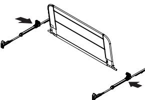
Con la pared de la barandilla completamente armada, ahora conecte los ensambles de la bisagra (F, G).
