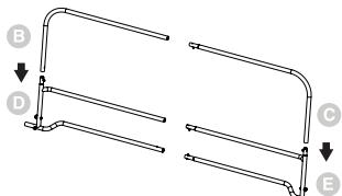
Insérez la barre de support supérieure (C) dans la barre de support inférieure (E). Assurez-vous que la cheville à ressort est bien insérée dans le trou opposé pour verrouiller les deux pièces. Répétez du côté contraire (B, D) du rail de lit.
