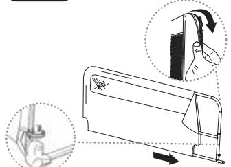
Pour installer la housse en tissu (A) sur la barrière de lit, glissez-la jusqu'à l'autre extrémité du cadre et fermez la fermeture éclair pour compléter la procédure. La paroi de mailles doit recouvrir entièrement le cadre du rail de lit.
