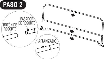
Con las barras de apoyo superior e inferior montados, conecte ambos lados.
