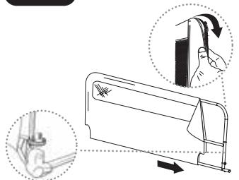
Para instalar la pared de malla (A) en la barandilla, deslicela sobre el marco hasta que llegue al extremo opuesto y cierre la cremallera para completar la instalación. La barrera de malla debe cubrir todo el marco del barandal para cama.
