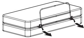
Serrez les sangles pour amener la barrière de lit à sa position adéquate. Pour les tendre, relâchez d'abord les boucles de retenue situées sous les barres de gauche et de droite. Tirez les sangles vers vous pour éliminer tout le jeu se trouvant sous le matelas.
