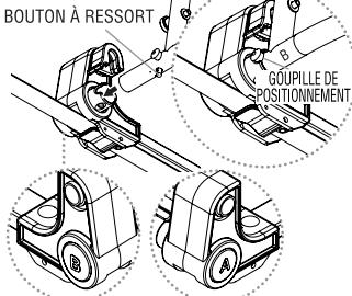
Insérez un côté du cadre mural avec la goupille de positionnement dans la assemblage de charnière étiquetée «B». Appuyez sur le bouton à ressort métallique pour insérer complètement le tube dans l'ouverture de la charnière en plastique. Le bouton à ressort doit être aligné avec le trou d'accès du manchon de plastique de la charnière. Le bouton à ressort doit ressortir et se bloquer en place dans le tube. Répétez l'opération pour assemblage de charnière opposé «A».
