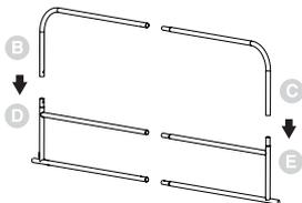
Introduzca la barra de apoyo superior (C) en la barra de apoyo inferior (E). Cerciórese de que el pasador de resorte encaje firmemente en el orificio opuesto de modo que las dos piezas no puedan separarse. Repita en el lado opuesto (B, D) del barandil para cuna.
