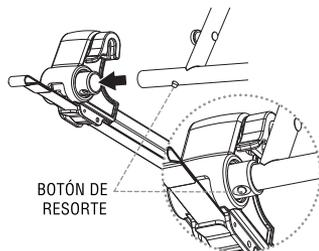
Introduzca un lado del marco de la pared en una de las patas. Presione el botón de resorte metálico para introducir completamente el tubo en el orificio de la bisagra plástica. El botón de resorte debe quedar alineado con el orificio de acceso en el manguito plástico de la bisagra. El botón de resorte botará y trabará el tubo en su lugar. Repita el proceso para completar el montaje de la otra pata.
