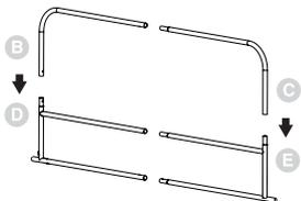
Insérez la barre de support supérieure (C) dans la barre de support inférieure (E). Assurez-vous que la cheville à ressort est bien insérée dans le trou opposé pour verrouiller les deux pièces. Répétez du côté contraire (B, D) du barreau pour berceau.
