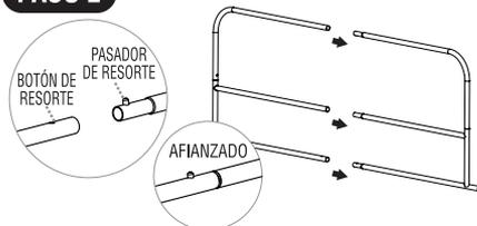
Con las barras de apoyo superior e inferior montados, conecte ambos lados.
