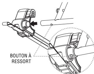
Insérez un côté du cadre du mur dans l'un des pieds. Appuyez sur le bouton à ressort métallique pour insérer complètement le tube dans l'ouverture de la charnière en plastique. Le bouton à ressort doit être aligné avec le trou d'accès du manchon de plastique de la charnière. Le bouton à ressort doit ressortir et se bloquer en place dans le tube. Répétez pour compléter l'assemblage de l'autre pied.
