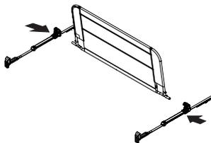
Con la pared del barandal para cuna completamente armada, ahora conecte los ensambles de la bisagra izquierdo (G) y derecho (F).
