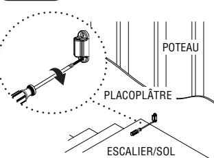
En utilisant les vis à bois de 2 po (5,08 cm) (I) fournies, vissez la charnière murale inférieure dans le placoplâtre et le poteau. Posez la vis du trou supérieur et celle du trou inférieur.
