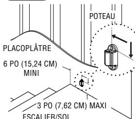
Les charnières s'installent du côté droit de l'escalier (lorsque l'on regarde l'escalier depuis le haut). En utilisant un détecteur de poteau de charpente, localisez dans le mur un poteau se trouvant à un **minimum** de 6 po (15,24 cm) du bord du palier supérieur. Une fois le poteau détecté, placez la charnière murale inférieure (E) contre le mur. Positionnez-la de sorte que le trou supérieur de la charnière murale inférieure soit à un **maximum** de 3 po (7,62 cm) au-dessus du plancher.
