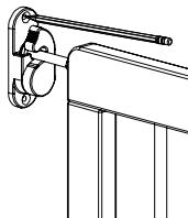
Avec la barrière en position fermée (créant un angle de 90° avec le mur sur lequel sont montées les charnières), placez la tige de réglage du récepteur dans le loquet mural (D). Marquez l'emplacement des trous, en vous assurant que vous êtes situé sur un poteau de charpente. Faites cette opération pour le récepteur supérieur et le récepteur inférieur.
