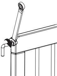
Una vez ajustado el espacio de 2.5", ajuste las 4 contratuercas con una llave de 13 mm. Una en cada perilla de ajuste de bisagra y una en cada perilla de ajuste del receptor.
