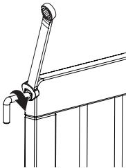
Une fois l'espacement maximum de 2,5 po (6,35 cm) réglé, serrez les 4 contre-écrous avec une clé de 13 mm. Un pour chaque tige de réglage de charnière et un pour chaque tige de réglage de récepteur.
