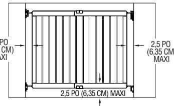
Lorsque la barrière est en position fermée et verrouillée, il ne doit pas y avoir plus de 2,5 po (6,35 cm) d'espace entre le mur et le premier barreau de chaque côté. Pour cela, tournez dans un sens ou dans l'autre les tiges de réglage des charnières et/ou les tiges de réglage des récepteurs.
