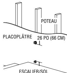
Répétez l'opération avec la charnière murale à clipser femelle (B). La distance entre le trou supérieur de la charnière murale inférieure et le trou inférieur de la charnière murale à clipser femelle est de 26 po (66 cm).
