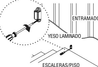
Utilice los tornillos de madera de 2" (I) provistos para colocar la bisagra de pared de montaje inferior en el yeso laminado y entramado. Repita el proceso para el agujero inferior y superior.
