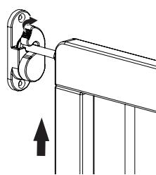
Pour ouvrir la barrière. Tournez le loquet du loquet mural dans le sens des aiguilles d'une montre pour ouvrir la barrière. Soulevez la barrière et poussez-la dans la direction opposée à l'escalier. Faites pivoter la barrière jusqu'à ce qu'elle soit complètement ouverte.
