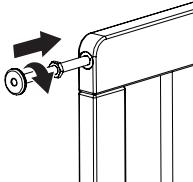
Vissez la tige de réglage de récepteur (H) supérieure dans le deuxième panneau de la barrière. Répétez l'opération avec la tige inférieure. Lorsque vous tournez la tige du récepteur dans le sens des aiguilles d'une montre, le récepteur se rapproche de la barrière. Desserrez complètement le contre-écrou.
