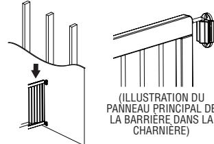
Placez le panneau principal de la barrière sur lequel sont montées les tiges de réglage des charnières dans les charnières supérieures et inférieures fixées au mur. Appuyez sur le panneau principal de la barrière vers le bas pour introduire les tiges de réglage de charnière dans les charnières.
