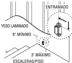
Las bisagras se instalan del lado derecho de las escaleras (al estar de frente a las escaleras hacia abajo). Utilice un localizador de entramados para ubicar un entramado en la pared que esté a un **mínimo** de 6° de la orilla del escalón superior. Una vez ubicado el entramado, coloque la bisagra de pared de montaje inferior (E) contra la pared. Colóquela de manera que el agujero superior de la bisagra del montaje inferior quede a un **máximo** de 3° por encima del piso.
