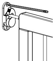
Estando la puerta en posición cerrada (creando un ángulo de 90° con la pared en donde están instaladas las bisagras) coloque la perilla de ajuste del receptor en el montaje de pared del ensamble del cerrojo (D). Marque la ubicación de los agujeros, y asegúrese de que estén sobre un entramado. Repita el paso anterior para el receptor superior e inferior.
