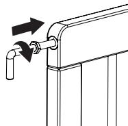
Atornille la perilla de ajuste de la bisagra (G) superior en el panel principal de la puerta (A). Repita el paso anterior con la perilla inferior. Gire la bisagra en dirección con las manecillas del reloj para ajustar la bisagra hacia adentro. Afloje la contratuerca completamente.
