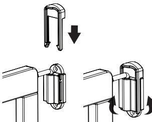
Coloque la bisagra de montaje de encaje hembra en la bisagra de montaje de pared de encaje macho. Empareje las "patas" de la bisagra de montaje de pared hembra sobre las ranuras y deslicelas hacia abajo hasta que se fijen en su lugar sobre la bisagra de montaje de pared de encaje macho (C).
