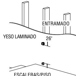
Repita el paso anterior con la bisagra hembra de encaje de montaje inferior (B). La distancia entre el agujero superior de la bisagra de montaje inferior y el agujero inferior de la bisagra hembra de encaje de montaje de pared es de 26°.
