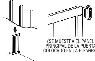
Coloque el panel principal de la puerta con las perillas de ajuste de la bisagra en las bisagras superior e inferior en la pared. Presione el panel principal de la puerta con un movimiento hacia abajo para colocar las perillas de ajuste de las bisagras dentro de las bisagras.
