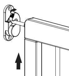
Para abrir la puerta. Gire el cerrojo del ensamble del cerrojo de montaje en la pared en dirección con las manecillas del reloj para abrir la puerta. Levante la puerta hacia arriba y empuje hacia afuera en dirección opuesta a las escaleras. Gire la puerta sobre las bisagras hasta que quede completamente abierta.
