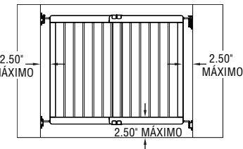
Cuando la puerta esté cerrada y bloqueada, no debe haber un espacio mayor a 2.5" desde la pared hasta el primer poste en los dos lados. Para lograr esto, gire las perillas de ajuste de las bisagras hacia adentro o afuera, y/o las perillas de ajuste del receptor.
