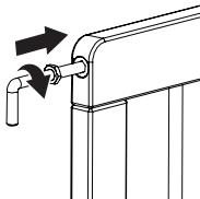
Vissez la tige de réglage de la charnière (G) supérieure dans le panneau principal de la barrière (A). Répétez l'opération avec la tige inférieure. Lorsque vous tournez la tige de la charnière dans le sens des aiguilles d'une montre, la charnière se rapproche de la barrière. Desserrez complètement le contre-écrou.
