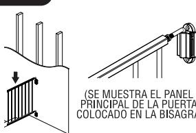
(SE MUESTRA EL PANEL PRINCIPAL DE LA PUERTA COLOCADO EN LA BISAGRA)
