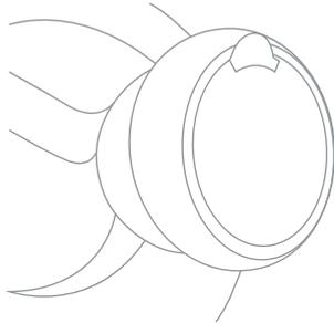
2. Insérez verticalement la bouteille sur le support (#1) qui se trouve en haut de la machine. Le support compte avec une tige perforante pour pouvoir ainsi utiliser des bouchons anti-écoulement sans devoir ouvrir le scellé de la bouteille en plastique.
