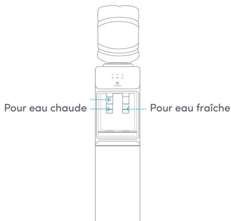
4. Une fois que l'eau coule des deux jets d'eau, connectez le dispositif à une prise. Allumez (I) l'interrupteur de chauffage (#12) et de réfrigération (#11). (Si vous ne voulez pas avoir d'eau chaude, laissez l'interrupteur de chauffage (#12) sur sa position éteinte (O). Si vous ne voulez pas d'eau fraîche, laissez l'interrupteur de réfrigération (#11) sur sa position éteinte (O).)
