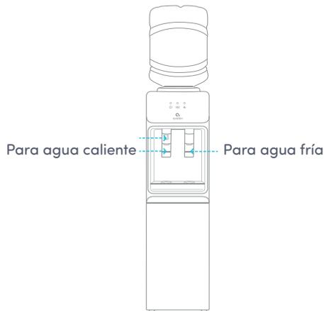
4. Una vez que el agua fluye desde ambos chorros, conecte el dispositivo a un enchufe. Encienda (I) el interruptor de calentamiento (#12) y el interruptor de refrigeración (#11). (Si no desea tener agua caliente, deje el interruptor de calentamiento (#12) en posición cerrada (O). Si no desea tener agua fría, deje el interruptor de refrigeración (#11) en posición cerrada (O).)
