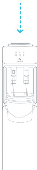
4. Placez un grand seau sous la sortie de drainage (#14) située derrière le dispositif. Enlevez le bouchon de drainage et laissez couler l'eau pour drainer le dispositif. L'eau commencera à se drainer dès que vous enlèverez le bouchon de drainage.
