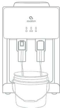
6. Una vez finalizado el drenaje, vuelva a colocar el tapón de drenaje, conecte y vuelva a usar normalmente la máquina.
