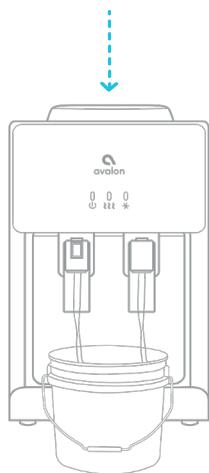
4. Coloque un gran cubo debajo de la salida de drenaje (#12) situada detrás del dispositivo y deje que el agua se drene de la máquina. El agua empezará a fluir en cuanto quite el tapón de drenaje.
