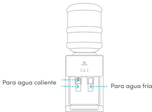
4. Una vez que el agua fluye desde ambos chorros, conecte el dispositivo a un enchufe. Encienda (I) el interruptor de calentamiento (#13) y el interruptor de refrigeración (#14). (Si no desea tener agua caliente, deje el interruptor de calentamiento (#13) en posición cerrada (O). Si no desea tener agua fría, deje el interruptor de refrigeración (#14) en posición cerrada (O).)
