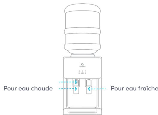
4. Une fois que l'eau coule des deux jets d'eau, connectez le dispositif à une prise. Allumez (I) l'interrupteur de chauffage (#13) et de réfrigération (#14). (Si vous ne voulez pas avoir d'eau chaude, laissez l'interrupteur de chauffage (#13) sur sa position éteinte (O). Si vous ne voulez pas d'eau fraîche, laissez l'interrupteur de réfrigération (#14) sur sa position éteinte (O).)
