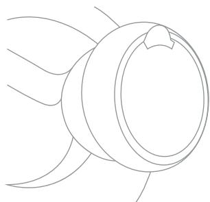
2. Insérez verticalement la bouteille sur le support (#8) qui se trouve en haut de la machine. Le support compte avec une tige perforante pour pouvoir ainsi utiliser des bouchons anti-écoulement sans devoir ouvrir le scellé de la bouteille en plastique.
