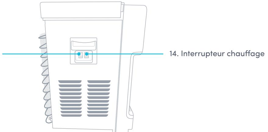
14. Interrupteur chauffage
