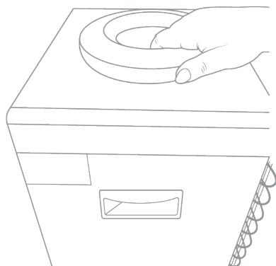
2. Mettez le mélange dans le réservoir d'eau froide de la machine et vérifiez que l'eau puisse couler à travers le jet d'eau chaude (#9).
