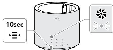
3. 電源ボタンを押すと、インジケーターが消灯し、内部乾燥機能が終了します。
