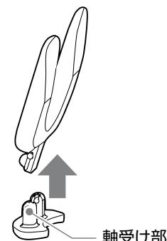
3. 取り付けの際はフロートの先端を上向きにして軸受け部に差し込みます。
