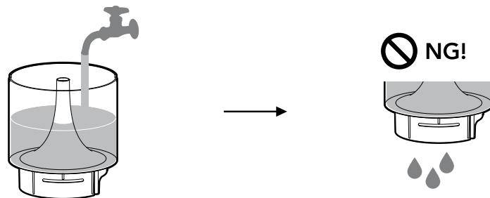
! タンクキャップは給水制御も行うため、取り付けずに使用すると水漏れが発生します。
