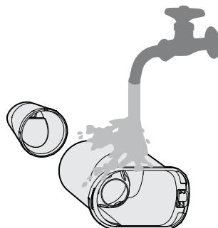
8. 残ったタンクの水を捨てタンクキャップを取り外し、水道水でタンク内と、タンクの裏側をスポンジなどで水洗いします。
