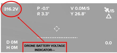
REFERENCE IMAGE OF THE REMOTE CONTROL LCD DISLAY SCREEN WHEN THE REMOTE IS POWERED ON. NOTE THE BATTERY VOLTAGE INDICATOR IS SHOWN AS 16.2V
