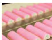
加熱された製品は、冷却装置で一気に冷却されます。加熱と冷却のラインを連続させることで、製品に余分な菌が付着・侵入することを防止。このクリーンな製造工程が合成保存料無添加を実現しました。
