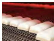
蒲鉾は“蒸す”、竹輪は“焼く”、揚物は“揚げる”など必要に応じた加熱作業が行われます。蒲鉾は低温と高温の二度蒸しでふりふりとした食感を演出。遠赤外線によって美味しい焼き色を表面に描きます。
