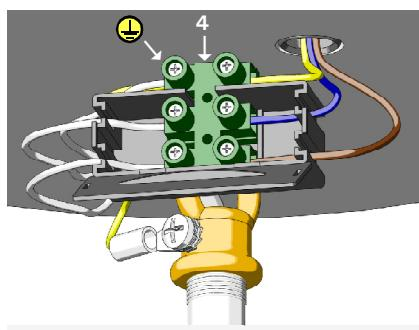
Aprire il morsetto (4) e effettuare i collegamenti elettrici rispettando le posizioni dei cavi come indicato in figura e sul morsetto stesso. Chiudere il morsetto, portare il rosone in battuta al soffitto e fissarlo avvitando il grano (1).
