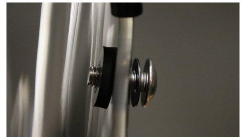
Figuur 7. Monteer volgorde op de beugel
