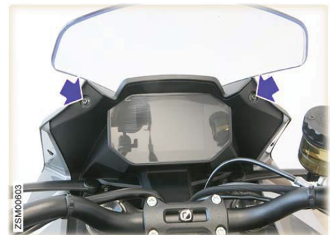
Figura 2. Retire los pernos largos (2x)
