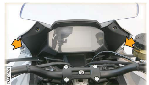
Figuur 3. Verwijder korte bouten (2x)
