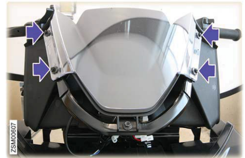
Figura 5. Rimuovere i bulloni lunghi (4x)
