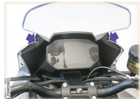
Figura 2. Rimuovere i bulloni lunghi (2x)
