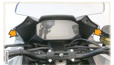
Figura 3. Rimuovere i bulloni corti (2x)
