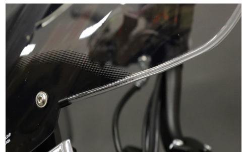
Figura 8. Profilo in gomma del parabrezza
