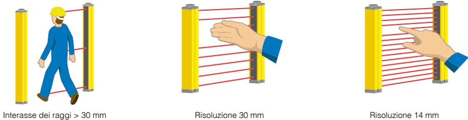
FIG. 1: CAPACITÀ DI RILEVAZIONE DELLA BARRIERA DI CONTROLLO DEGLI ACCESSI O DELLA BARRIERA FOTOELETTRICA
