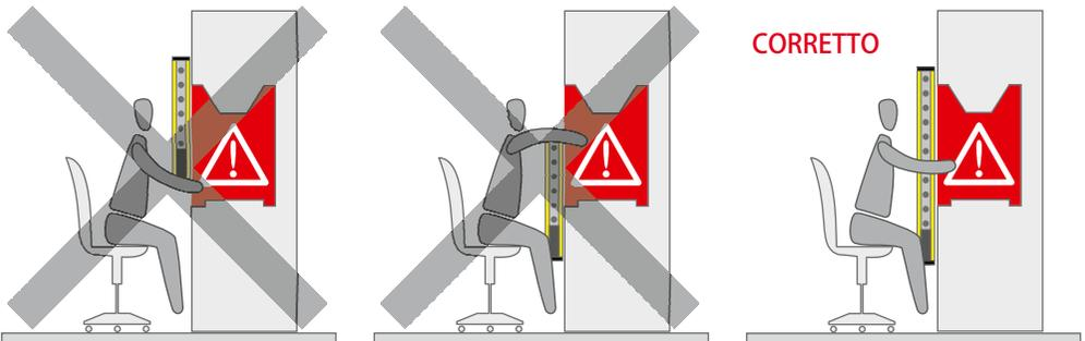
FIG. 9: POSIZIONAMENTO DELLA BARRIERA FOTOELETTRICA DI SICUREZZA
