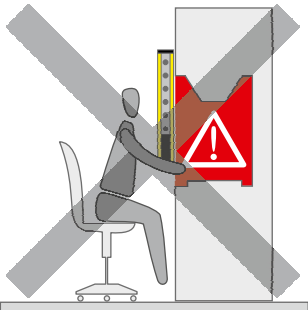
FIG. 9 : POSITIONNEMENT DE LA BARRIÈRE IMMATÉRIELLE DE SÉCURITÉ
