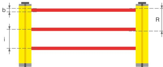
FIG. 7: RESOLUCIÓN DE UN AOPD
