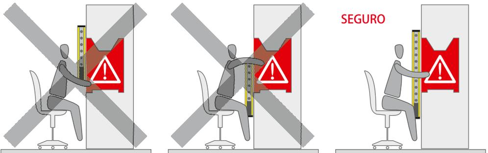
FIG. 9: POSICIONAMIENTO DE LA CORTINA ÓPTICA
