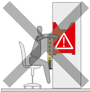
FIG. 9: O POSICIONAMENTO DA BARREIRA DE SEGURANÇA FOTOELÉTRICA
