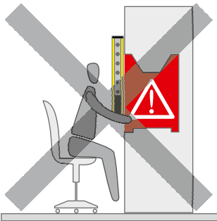
FIG. 9: O POSICIONAMENTO DA BARREIRA DE SEGURANÇA FOTOELÉTRICA
