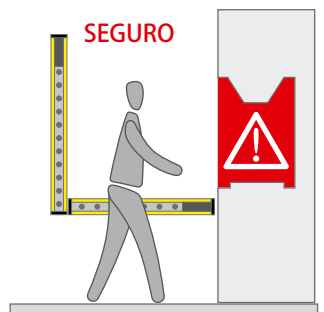
FIG. 10: INSTALAÇÃO DA BARREIRA DE SEGURANÇA FOTOELÉTRICA EM FORMA DE L
