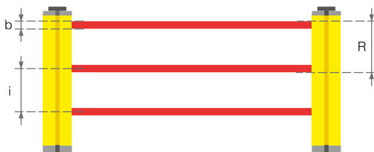
FIG. 7: RESOLUÇÃO R DE UM DOPA
