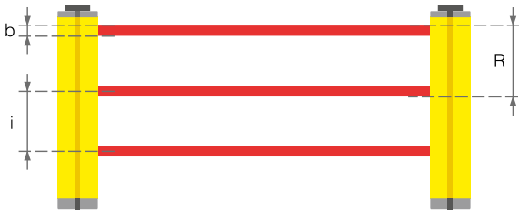
FIG. 7: RISOLUZIONE O CAPACITÀ DI RILEVAZIONE (R) DI UN AOPD
