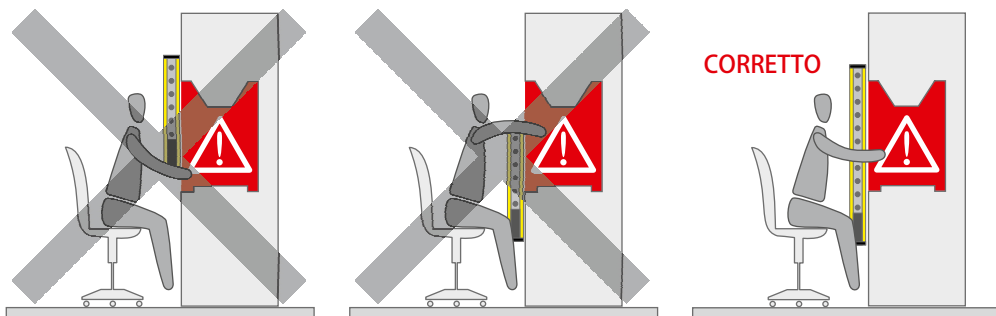
FIG. 4: POSIZIONAMENTO DELLA BARRIERA FOTOELETTRICA DI SICUREZZA
