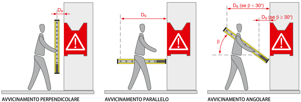
FIG. 6: DISTANZA MINIMA DI SICUREZZA (USA E CANADA)
