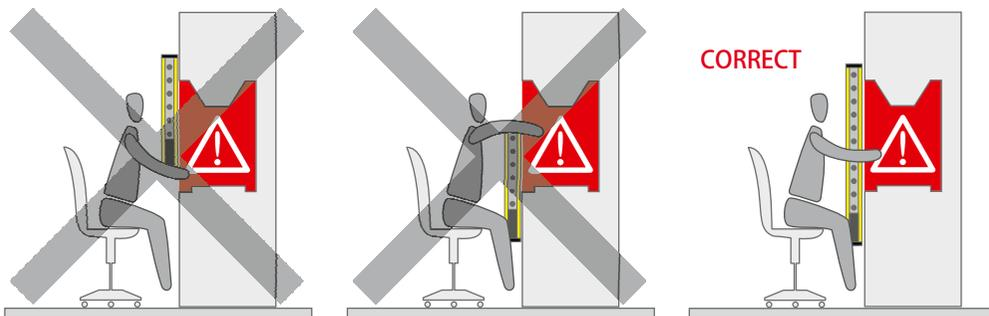
FIG. 4 : POSITIONNEMENT DE LA BARRIÈRE IMMATÉRIELLE DE SÉCURITÉ
