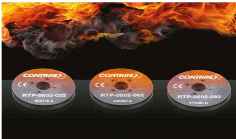
I **Tag LF ad Alta Temperatura**, e incorporabili sono adatti per applicazioni da -40 a +180° C. Grazie alle custodie interamente in metallo, acciaio inossidabile (V4A / AISI 316L), sono adatti agli ambienti alimentari, resistenti alla corrosione e ai solventi aggressivi. Il diametro del Tag è di 26 mm e, se usato con un RWM M30 Basic LF, la distanza massima di Lettura/Scrittura è di 26 mm.
