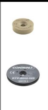
Diseñados para entornos de hasta 180 o 250°C, los tags de HIGH TEMPERATURE ofrecen una longevidad excepcional y una fiabilidad de ciclos térmicos de 1000 horas (o 1000 ciclos). Los tags son insensibles a la suciedad y proporcionan entre 128 y 2048 bytes de memoria de usuario. Como dispositivos pasivos, no se requiere batería u otra fuente de alimentación. Las carcasas son impermeables (IP 68 e IP 69K).
