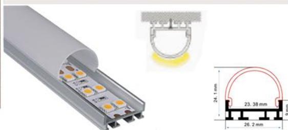
Perfil con el difusor redondeado para tiras de LED flexibles. Opcional instalarlo como una luminaria lineal a consultar.
