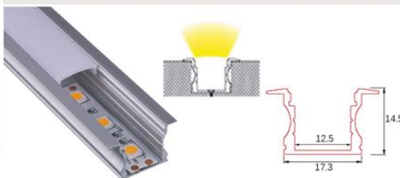
Perfil aluminio alto de empotrar con aletas evitando verse los puntos de las tiras de LED. Luz integrada sin una alta luminosidad.
