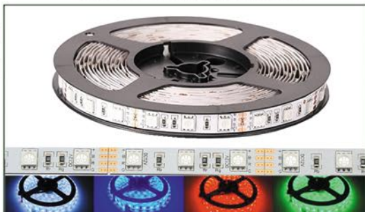
Rollo de tira LED por 5 metros serie Eco, garantía 1 año. Tiras de LED RGB multicolor 14,4W 5050 en 12V ó 24V.
