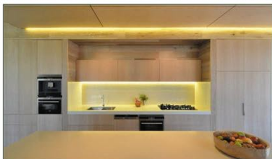
Perfil de aluminio para superficie micro alto, para evitar verse los puntos de las tiras de LED en exceso.
