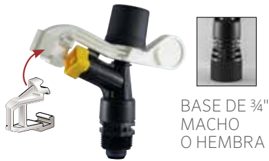
El difusor distribuye parte del agua más cerca del aspersor para lograr una mejor uniformidad de aplicación.
