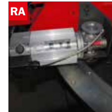
Dispositivo di rotazione arco automatica con comando da motore C.C. Bow mitre rotation controlled by DC motor
