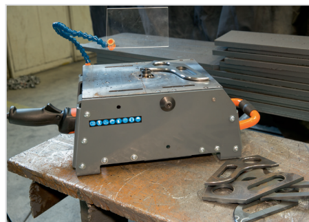
Straight edge bevelling guide
