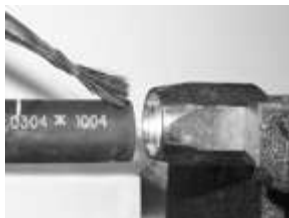
Aplicar lubricante a la cubierta de manguera.
