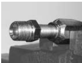
Atornillar la espiga dentro del socket.
