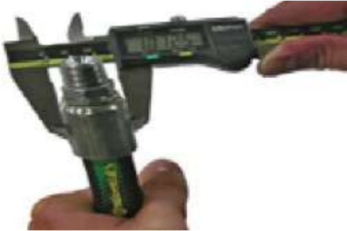
Verificar diámetro de crimpado con calibrador.
