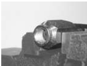
Chequeo visual de la posición de manguera dentro del socket.
