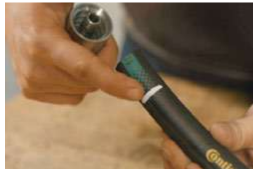
Marca de profundidad de inserción.
