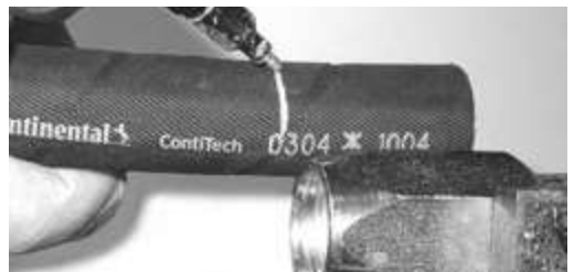
Marcar profundidad de inserción.
