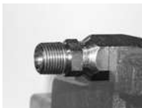
Espiga bien asentada contra el socket.
