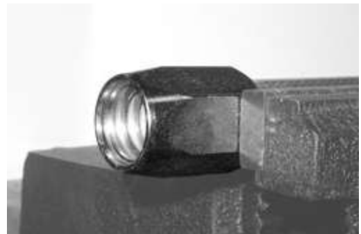
Socket posicionado en tornillo de banco.
