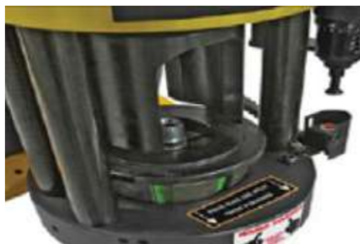
Insertar el ensamble de manguera dentro del dado.
