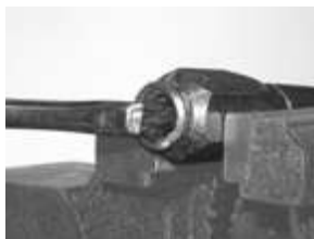
Aplicar lubricante a la espiga y el tubo de la manguera.
