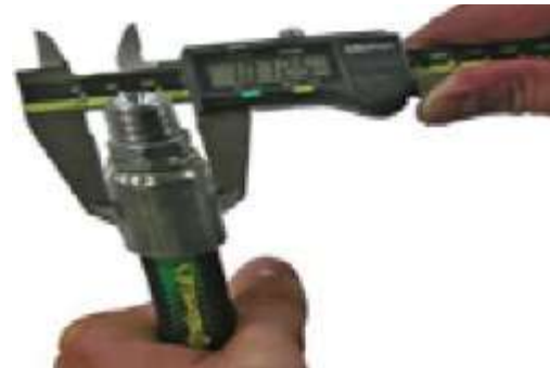
Verificar diámetro de crimpado con calibrador.
