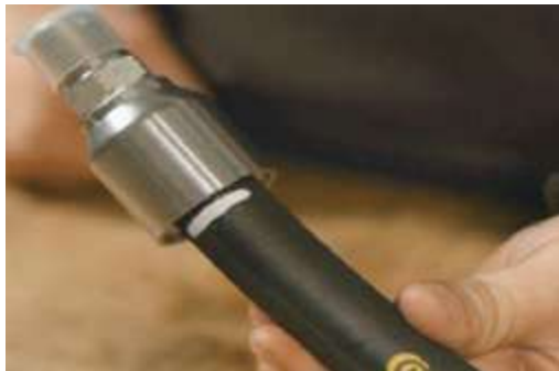
Insertar la conexión en la manguera.
