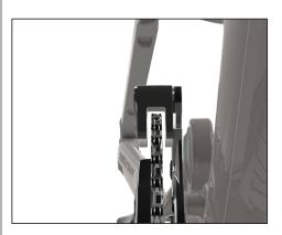
10. EVERYTHING SHOULD NOW BE FITTED. DOUBLE CHECK THE CHAINLINE IS GOOD AND THERE IS NO EXCESSIVE RUBBING ON THE GUIDE, ESPECIALLY WHEN IN THE LARGEST / SMALLEST SPROCKETS.
