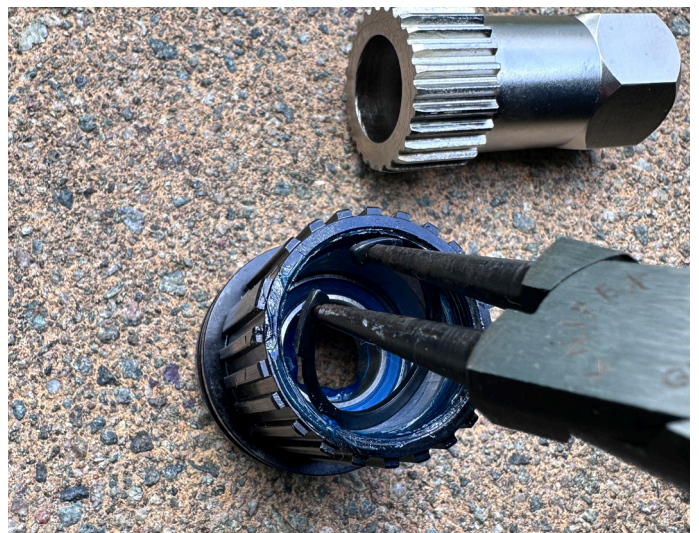
28. Replace the circlip
